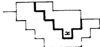
Figure 7. Cône d'extraction  $\Gamma$  d'un bloc  $x$ .
