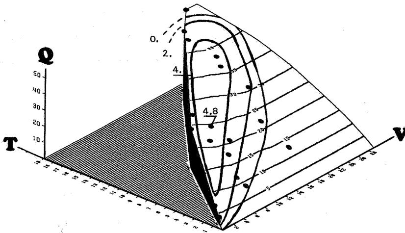
Figure 9. L'optimum économique. Valorisation des carrières  $B = Q - 1,4T - 0,75V$ .
