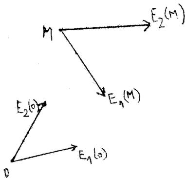
On sait que la méthode tellurique repose sur la correspondance entre les vecteurs électriques  $E(O)$  et  $E(M)$  observés au même instant en un point  $O$  pris comme origine et en un point  $M$  variable sur la surface topographique. Cette correspondance est linéaire, de sorte que si  $E_1(O)$ ,  $E_2(O)$  et  $E_1(M)$ ,  $E_2(M)$  sont deux couples de vecteurs homologues en  $O$  et  $M$ , tout vecteur
