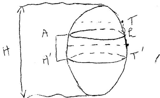
Etant donné un amas, géométriquement assimilable à un ellipsoïde, reconnu par n sections équidistantes, il a déjà été démontré que la variance relative  $\frac{\sigma^2}{V^2}$ , donnant la précision avec laquelle le volume V de l'amas était estimé à partir des n sections d'aires  $S_1, S_2 \dots S_n$  avait pour expression. (cf. formules XI, 6).
