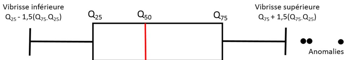
Figure 24 : Schéma d'une boîte de dispersion.
